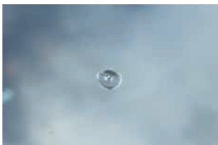
Hier ist eine Reparatur noch möglich.
